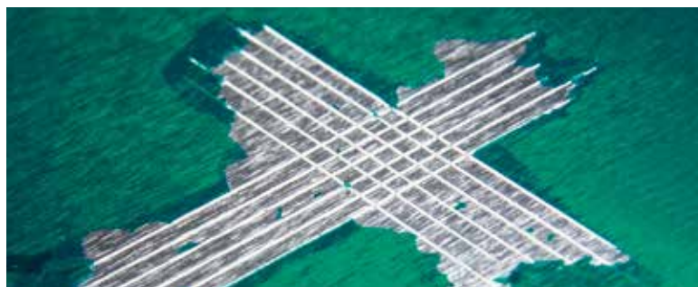
Tinta aplicada sem o pré-tratamento de silano
