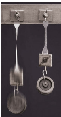
Термореактивная характеристика полиэтилена при 200 °C (392 F), DIN EN 60811-2-1
