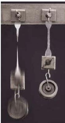
Wie die Abbildung zeigt, ist nicht vernetztes Polyethylen sehr leicht verformbar. Mittels Silanvernetzung behält das geschmolzene Polymer seine Dimensionsstabilität bei. Die Deformation des vernetzten Polyethylens ist minimal (siehe rechtes Testobjekt im Bild). Im Gegensatz dazu reißt das nicht vernetzte Polyethylen
